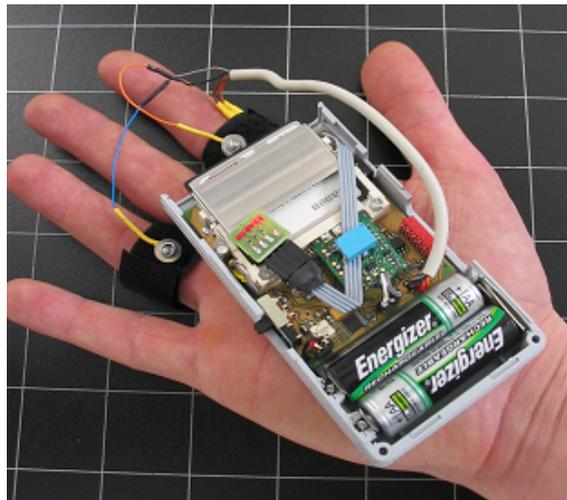
**Abbildung 4.5:** Sensorik und Steuergerät zur Erfassung der physiologischen Größen Puls, Hautwiderstand und Hauttemperatur
